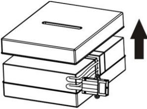
将电池包的上盖移开，更换旧电池。
