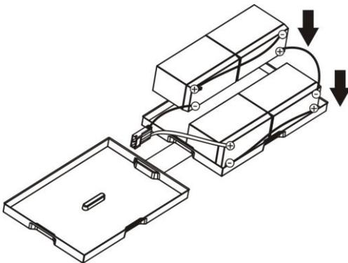
步骤 2: 依照下图连接电池端子。
