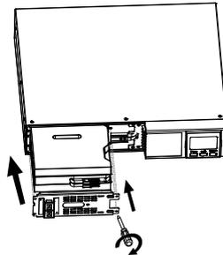
将更换后的电池包重新放回机器内，并将电池挡板螺丝锁回。
