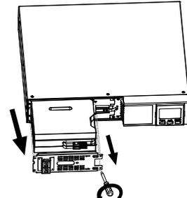
先将电池挡板上的螺丝取下，移除电池挡板后，将电池包拉出。
