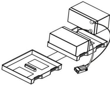
步骤 2: 依照下图连接电池端子。
