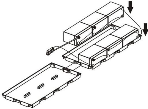
步骤 4: 依照下图将盖子盒上，此时，电池包已组装完毕。
